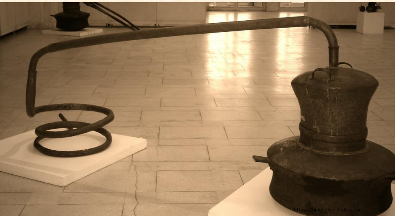
Cazan de țuică, din aramă, cu șeava în serpentină, secolul al XIX-lea.
